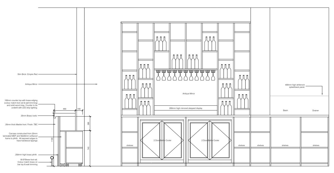
BAR BACK FITTING ELEVATION
